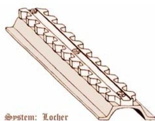
**System Locher:** Eduard Locher entwickelte die so genannte Fischgrätzenzahnstange. Die Doppelzahnstange mit Zähnen auf der rechten und linken Seite liegt in mitten des Gleises. Das Triebfahrzeug hat Zahnräder die dann seitlich eingreifen. Das eher seltene System wird man nicht oft sehen da es nur für extreme Steigungen verwendet wird. Man befürchtete das die Lokomotiven aus dem Gleis gehoben werden. **Bahnen:** Pilatusbahn (CH)
