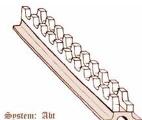
**System Abt:** Carl Roman Abt erfand die Lamellenzahnstange wo zwei oder drei Zahnstangen gegeneinander verschoben mit den Zähnen nach oben schauen. Die Triebfahrzeuge können natürlich ebenfalls zwei oder drei Zahnräder haben und greifen mit diesen in die Zahnstangen ein.
