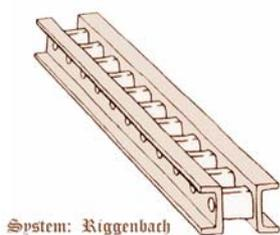
**System Riggenbach:** Ing. Niklaus Riggenbach ein Pionier in Sachen Zahnradbahn der Schweiz erfand die Leiterzahnstange. Diese Zahnstange hat links und rechts ein U-Profil das nach außen gerichtet ist und in der Mitte sind Zähne als Sprossen wie bei einer Leiter eingesetzt. Dieses System ist kompatibel mit dem System Von Roll.
