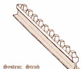
**System Strub:** Emil Viktor Strub entwickelte die Zahnkopfstange die wie folgt aussieht. Eine Breitfußschiene wird genommen und in diese werden die Zähne eingefräst. Die Zahnräder greifen von oben in die Zahnstange ein und dadurch besteht ein zusätzlicher Halt. Dieses System ist kompatibel mit dem System Von Roll. **Bahnen:** Wendelsteinbahn (D), Appenzellerbahn System Strub & Von Roll (CH), Jungfraubahn (CH), Ferrovia Monte Generoso (CH), Chemin de Fer de Martigny au Chätelard (CH), ect...
